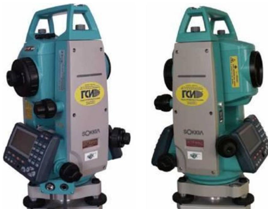
**Рисунок 3. Электронный тахеометр Sokkia SET 530RK3**
