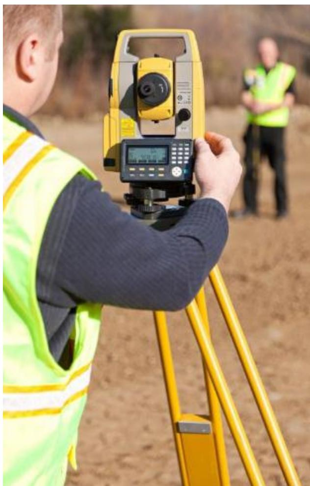
**Рисунок 7. Тахеометр Topcon ES-105L**
